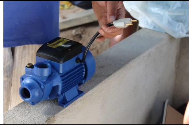
Figura 35: Bomba magnética com instalação de plug macho
